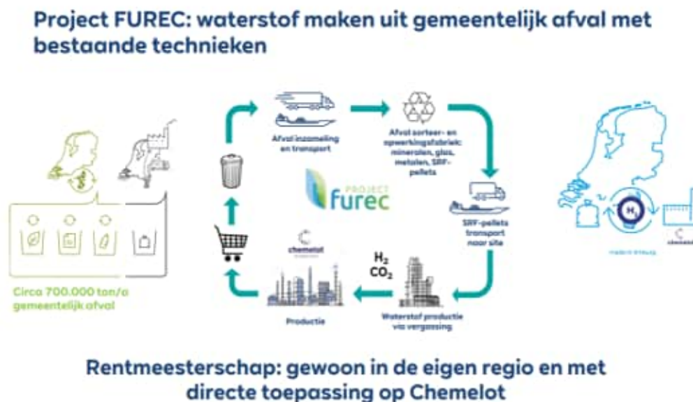
Figuur 16. Schematische weergave van het FUREC-initiatief (Bron: RWE 24 )
