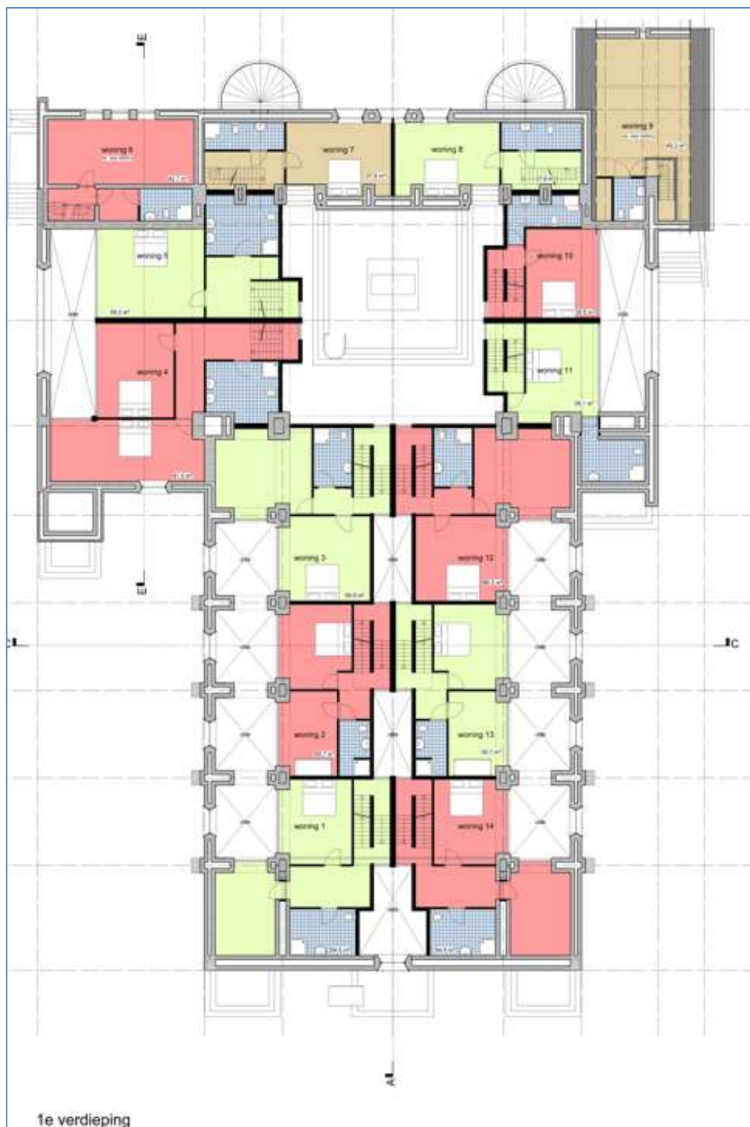
Figuur 11. Plattegrond 1 e verdieping
